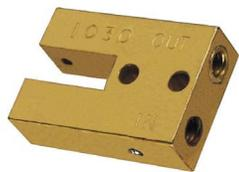
El sensor de separación sin contacto detectará cualquier objeto plano o curvo con un radio mínimo de 1/32". Produce una señal positiva cuando no hay ningún objeto presente y una señal negativa cuando un objeto interrumpe el sistema de detección.
